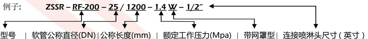
型号 | 软管公称直径(DN) | 公称长度(mm) | 额定工作压力(Mpa) | 带网罩型 | 连接喷淋头尺寸(英寸)
